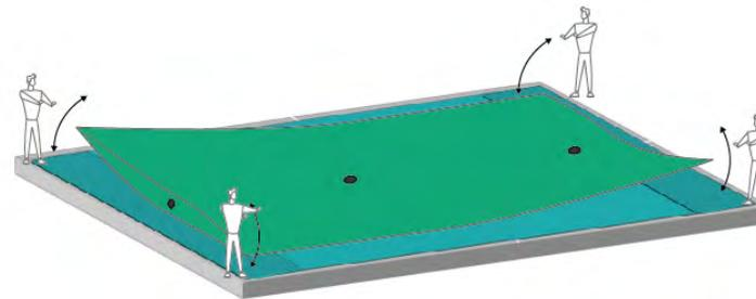
**NB:** Para desplegar, posicionar y tensar la cisterna, la sincronización de sus movimientos es indispensable.
