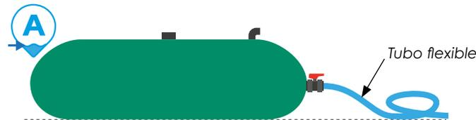
Vaciado por gravedad o vaciado por bomba
