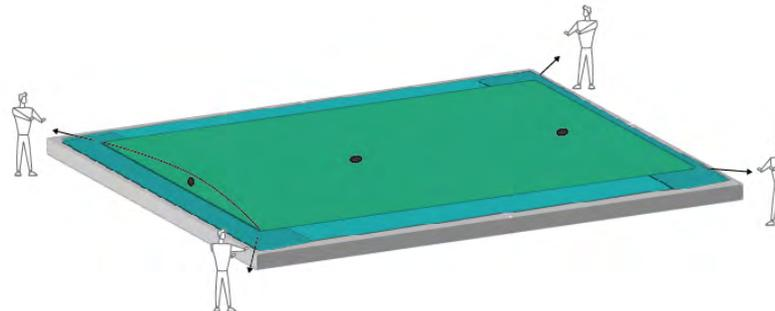
**NB:** Para desplegar, posicionar y tensar la cisterna, la sincronización de sus movimientos es indispensable.
